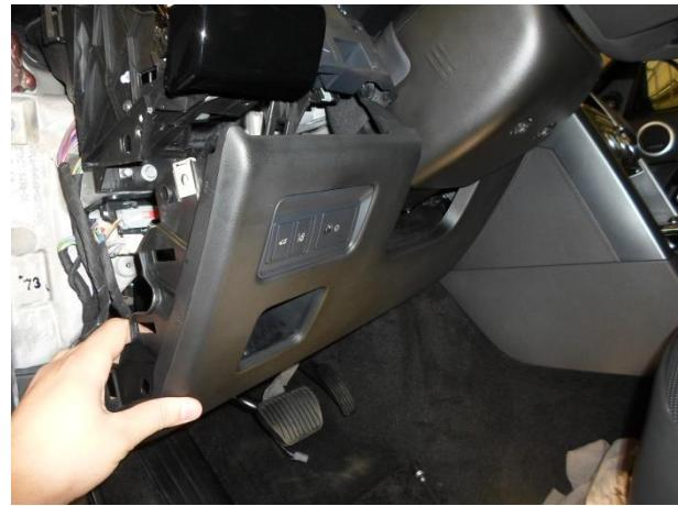
Снять панель. Отсоединить фишкы.
