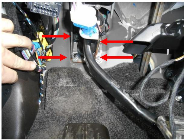
Отвернуть 4 гайки крепления вакуумного усилителя.
