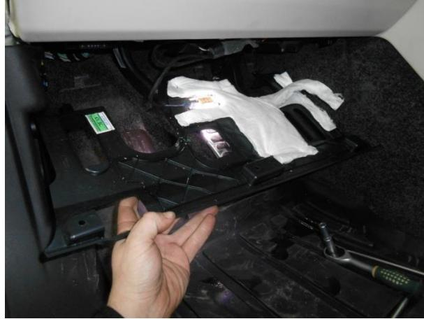
Снять панель, отсоединить фишку.
