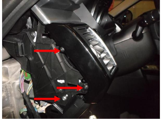
Вывернуть 3 болта. Снять панель.
